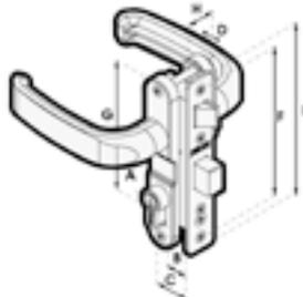
Para puertas de abatir. Con cilindro perfil europeo intercambiable por otros cilindros de alta seguridad. Las manijas operan el picaporte por ambos lados. El cerrojo se acciona con llave por ambos lados. Resbalón reversible para puertas izquierdas o derechas. Sistema Permax de fijación permanente de manijas (3050) ó con sistema independiente de retroceso de manijas por medio de resorte (3055).
