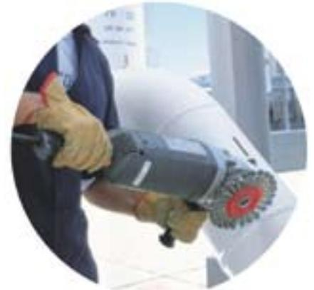
Estos cepillos se utilizan en máquinas fijas pudiéndose utilizar en máquinas portátiles en diámetros no superiores a 175 mm. y siempre con casquillo metálico orificio 22 mm.
